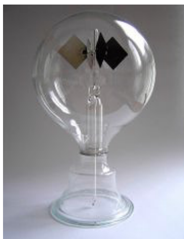
Figura 7.5: Un radiometro di Crookes e' costituito da una ventola con pale annerite su un lato e specchiate sull'altro in grado di ruotare con poco attrito in una ampolla contenete aria a bassa pressione ( 10^{-2}mm/Hg ).
